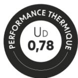
Le coefficient thermique  $U_d$  informe sur la capacité de la porte à isoler des variations thermiques entre l'intérieur et l'extérieur. Plus il est bas, plus la porte est isolante. Les valeurs de ce catalogue sont établies sur la base d'une porte un vantail selon la norme EN 14351-1:2006+A1:2010.
