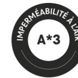
Noté sur une échelle allant de A1 à A4, A4 étant la valeur la plus imperméable. Cet indice permet d'évaluer le passage d'air extérieur par la porte d'entrée au sein de la maison.
