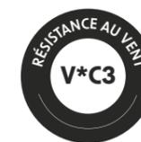
Noté sur une échelle allant de V1 à V5, V5 étant la plus résistante. Elle informe sur la résistance à la pression des rafales de vent. Puis de A à C en ce qui concerne la déformation liée au vent, C étant la meilleure valeur.
